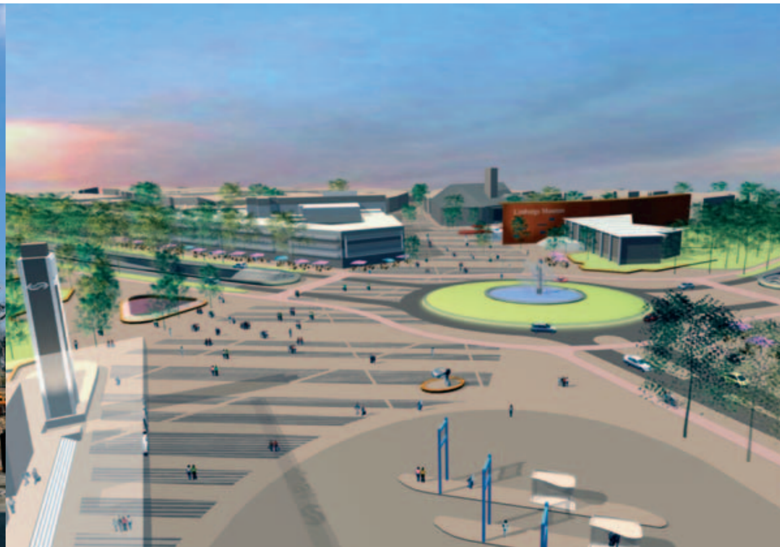
[68] Impressie van de in voorbereiding zijnde ondertunneling van het Koninginneplein. De tunnel volgt het tracé van de Koninginnesingel en de Burgemeester Van Rijnsingel. Daardoor ontstaat op het maaiveld meer ruimte voor langzaam verkeer tussen de binnenstad en het station.
